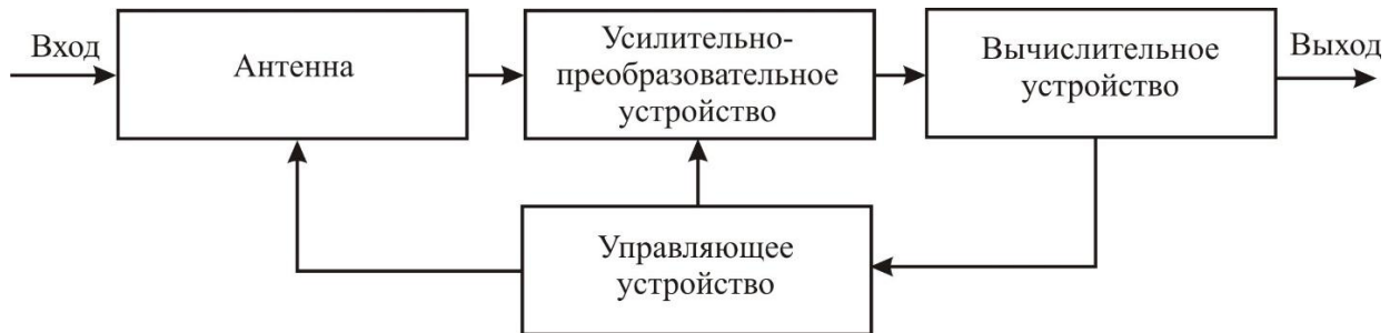
Рис. 1.1.2. Структура радиотехнической системы извлечения информации (радиоизмерителя)
